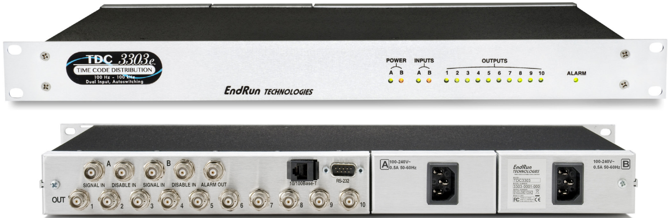
TDC3303 前面パネルと背面パネルの外観、オプションの二重冗長化電源をインストールした状態
